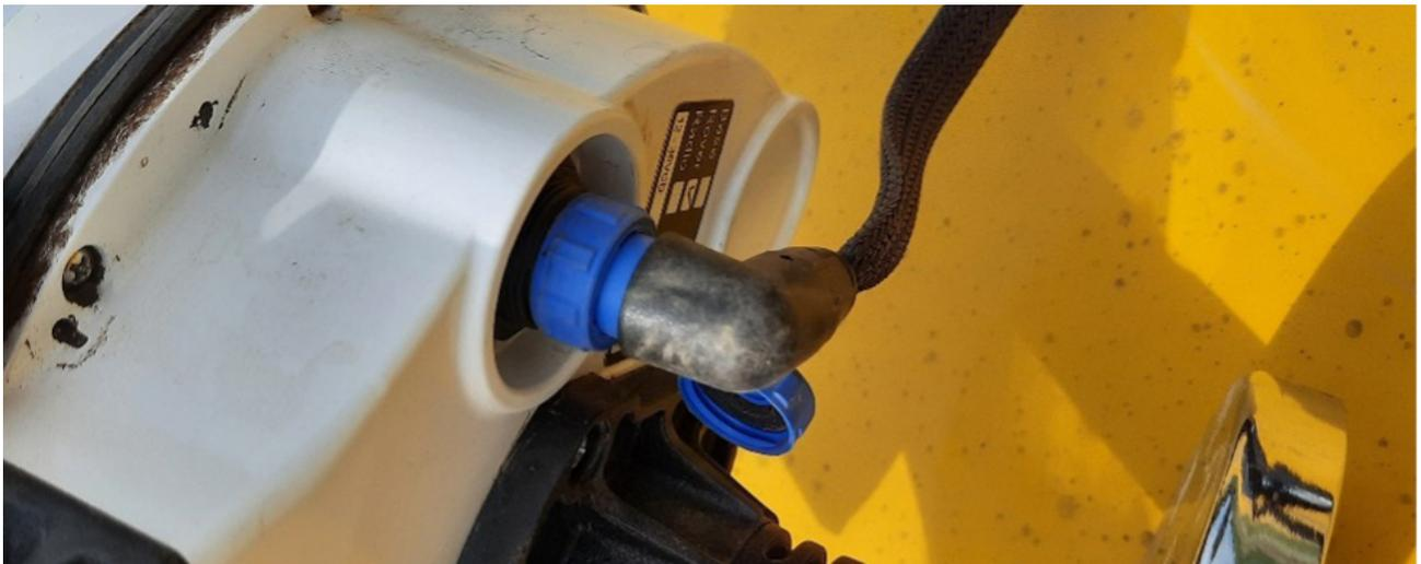
En caso de contar con módulo Antena GPS conecte la ficha del cable coaxial. ver "**Conexión de arneses del sistema**" en la página 26.
