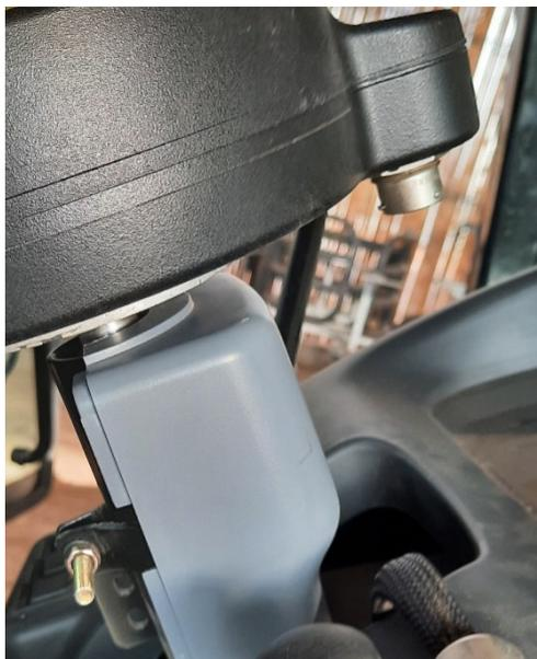
3. Instale la tuerca hexagonal de seguridad junto con la arandela grower en el eje de la columna de dirección quitada en el paso 2 de la sección *"Quitado de volante"* en la página 18'. Ajuste la tuerca con un tubo correspondiente a la medida y una manija de fuerza en sentido horario hasta que la tuerca quede suficientemente apretada.
