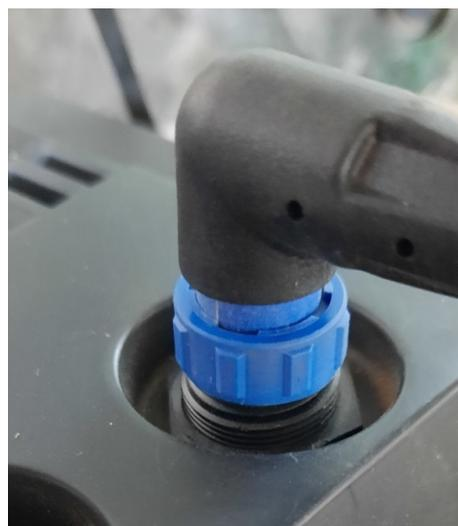
Si tiene módulo Antena GPS deberá conectar la ficha del cable coaxial que viene de mencionado módulo, al módulo Monitor. ver "*Conexión de arneses del sistema*" en la página 26.
