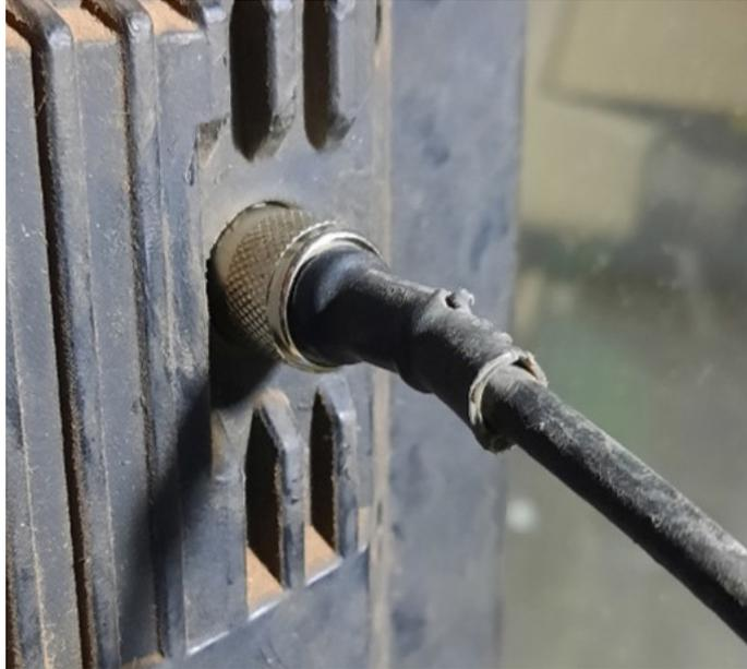
Para desconectarlo, desenrosque la tuerca en sentido contrario a las agujas del reloj hasta que quede floja y aleje el conector del módulo Monitor.
