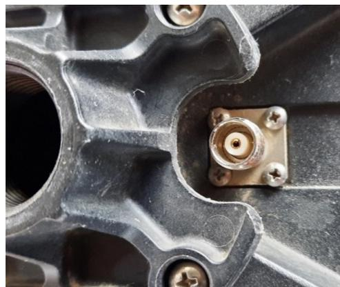
Inserte el conector y gire la tuerca en el sentido de las agujas del reloj para asegurar su sujeción.
