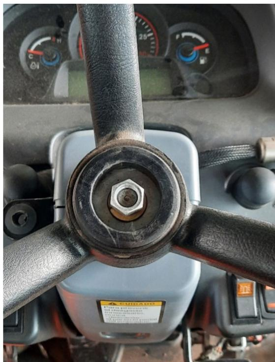
3. Usar un extractor de volante con perno compatible con la tuerca hexagonal, para quitar el volante.
