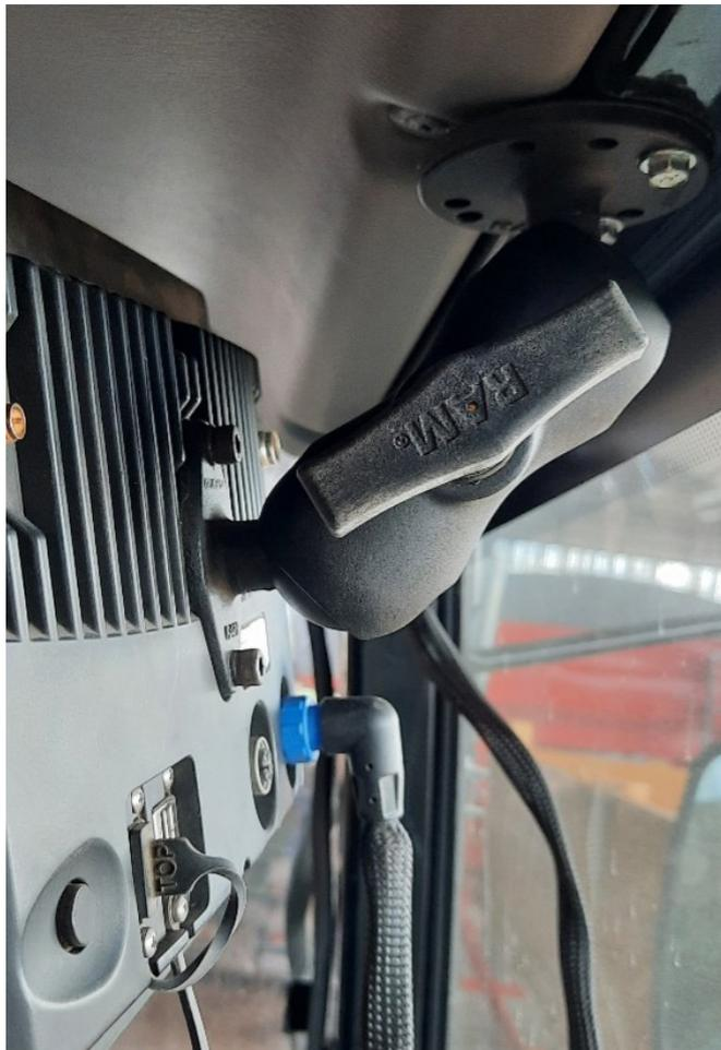
4. Ajuste la posición del monitor y el ángulo de visión de manera que quede cómodo para trabajar. Apriete la tuerca del soporte RAM en dirección de las agujas del reloj hasta que el módulo Monitor quede firme.
