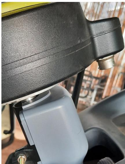
Deslice el pasador anti-rotación hacia arriba hasta que haga tope con la parte inferior del motor DirectDrive.
