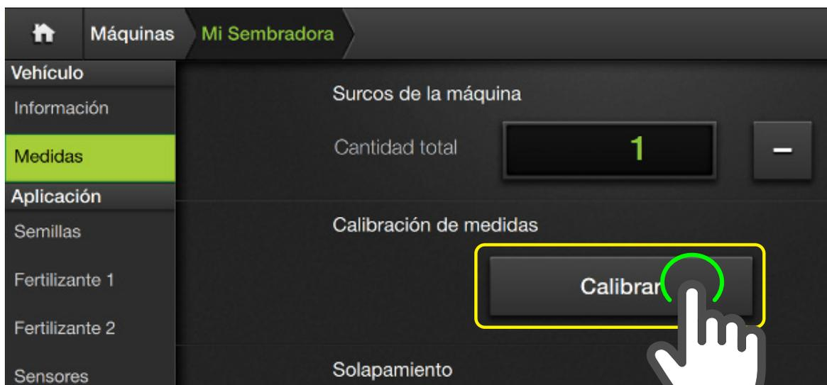
La calibración ajustará el valor de **Offset de implemento** y **ancho de trabajo**. Al finalizar, realizar 3 pasadas consecutivas para **verificar** en el **suelo** que la **distancia** entre las **pasadas** quedo correcta. En caso de ser **incorrecta** volver a realizar la **calibración** haciendo 3 pasadas nuevas, es decir, no se puede utilizar la última pasada de la calibración anterior.
