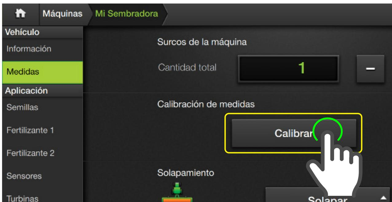
La calibración ajustará el valor de **Offset de implemento** y **ancho de trabajo**. Finalizada la calibración, realizar 3 pasadas consecutivas para **verificar** en el **suelo** que la **distancia** entre las **pasadas** haya quedado correcta. En caso de ser **incorrecta** volver a realizar la **calibración** realizando 3 pasadas nuevas, es decir, no se puede utilizar la última pasada de la calibración anterior.
