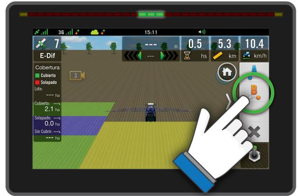
Una vez ubicado el vehículo en el punto inicial del trazado presionar el botón “A”, continuar hasta el punto final del trazado y presionar el botón “B”.
