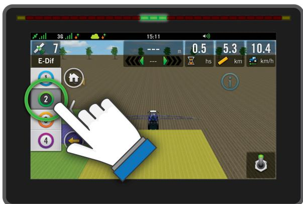
Presionando sobre cada uno de los botones numerados del panel, podremos **cambiar los widgets que se visualizan en pantalla**.
