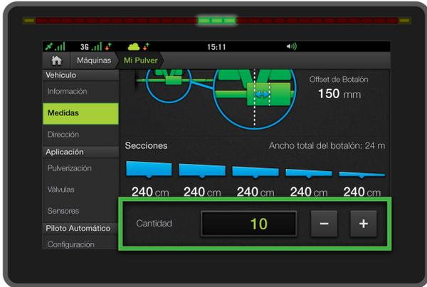
Una vez dentro de las opciones de la máquina y en la sección de **"Medidas"**, desplazar la pantalla hacia abajo para **ingresar la cantidad de secciones** (botones + y -, ó presionando dos veces sobre el valor).
