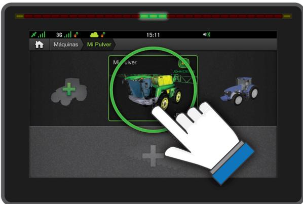
**Seleccionar la máquina a utilizar** ubicándola en el centro de la pantalla y luego ingresar a su respectivo menú presionando sobre la misma.
