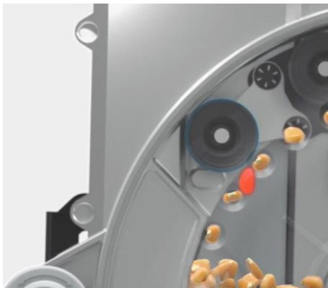
El ecuRow emplea un sistema enrasador de precisión, que impide los dobles en tres instancias, con agresividad progresiva, haciendo casi imposible que dos semillas ocupen el mismo orificio de la placa.
