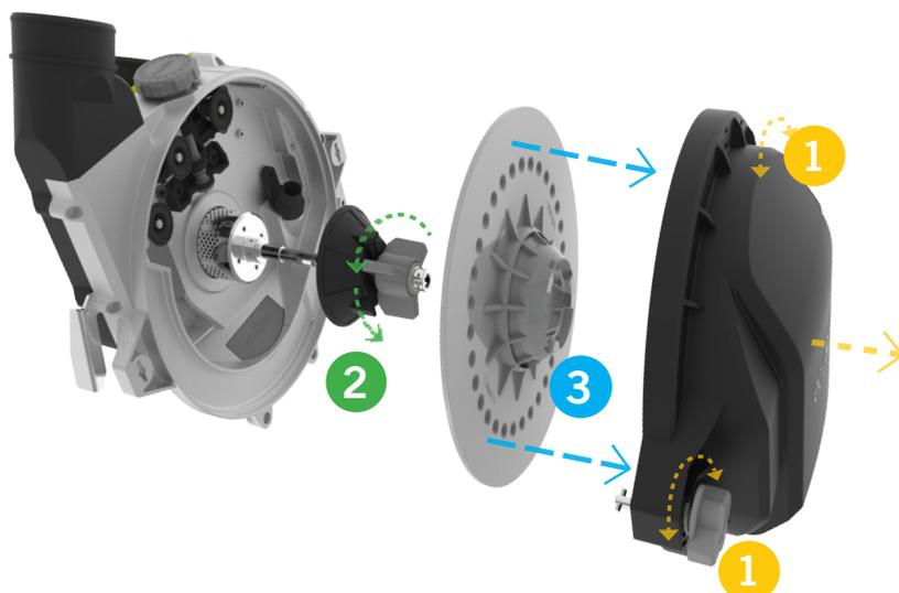
1. Presionar y girar 1/2 vuelta (en cualquier sentido) las **perillas de fijación** de la cubierta, y extraerla.
