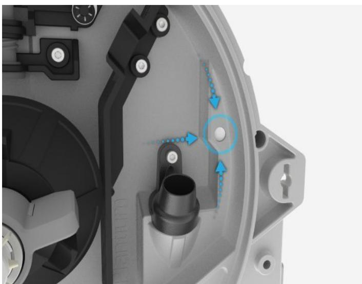
El sensor de presión diferencial integrado en el módulo, **mide la presión manométrica** en el interior de la cámara de semillas.
