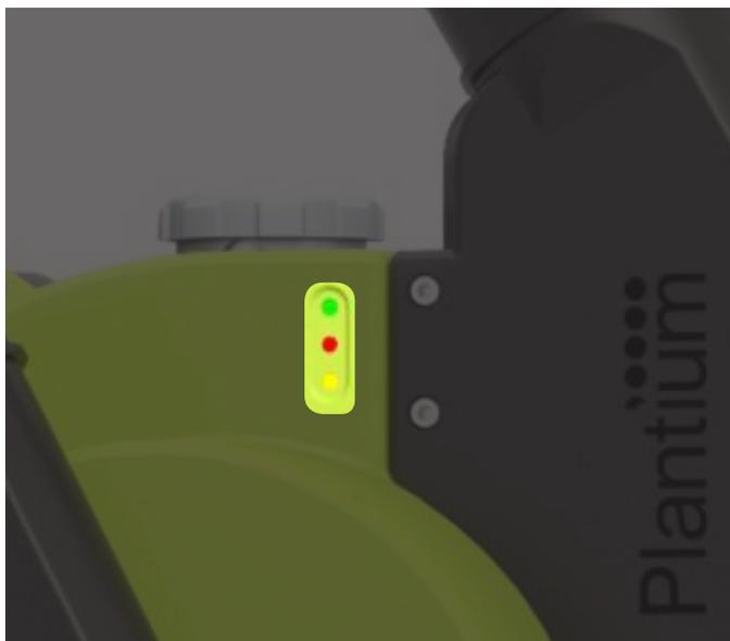
Unidad electrónica integrada para el control del motor y detección de semillas, con indicadores de luz LED:
