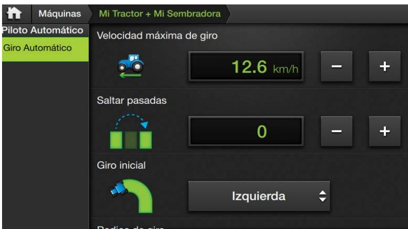
En esta solapa se establecen las configuraciones de la función que permite girar el vehículo automáticamente.
