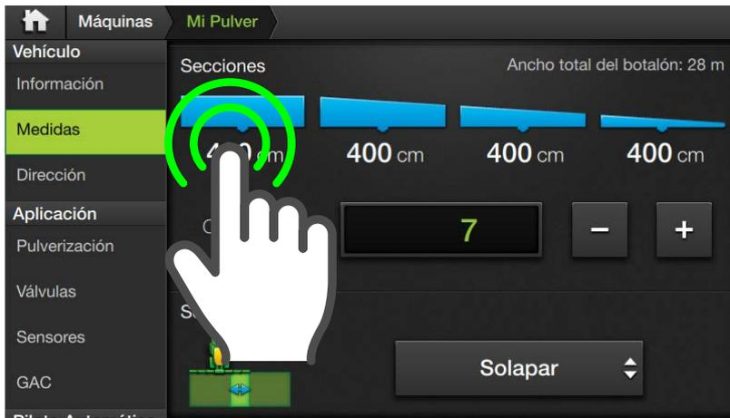
3. Continuar desplazando hacia arriba hasta **Secciones**, con los parámetros:
