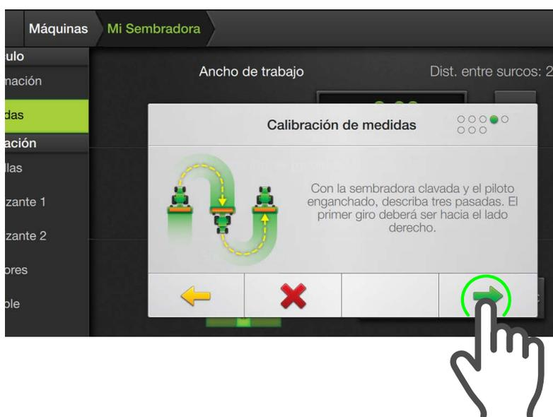
3. Verificar que se cumplan todas las condiciones. Enganchar piloto, bajar la sembradora y hacer tres pasadas ida-vuelta.
