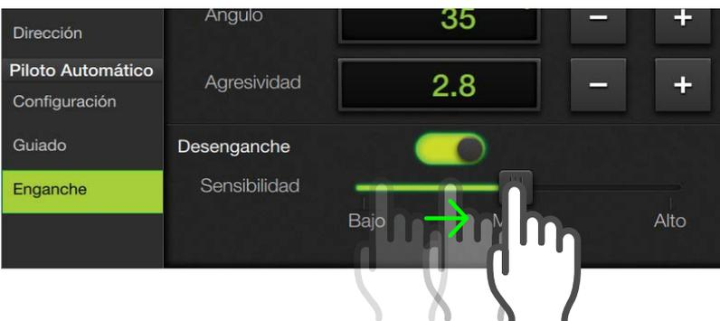
**Sensibilidad** determina el movimiento de volante necesario para llevar a cabo el desenganche.
