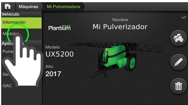
1. En el panel de **Máquinas** tocar sobre el implemento a editar y luego, presionar la solapa **Medidas**.
