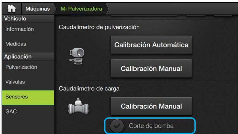
Si además la máquina posee una bomba de carga, se puede activar la opción **Corte de bomba** para que el sistema corte la carga automáticamente cuando se llega a la cantidad de litros deseados.
