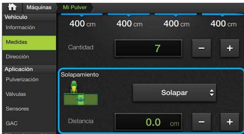
5. Continuar desplazando hacia arriba hasta que quede visible **Solapamiento**, con los parámetros:
