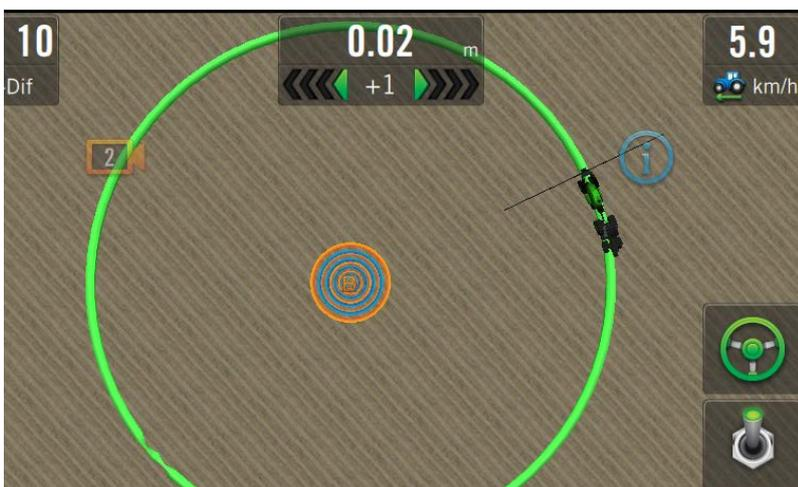
Mientras conduce, el círculo verde se irá expandiendo concéntricamente, conforme el desplazamiento de la máquina.
