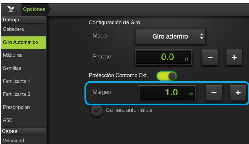
La distancia de **Margen** protege contra posibles corrimientos de la señal de GPS, error de guiado, errores en las medidas de la máquina, etc.
