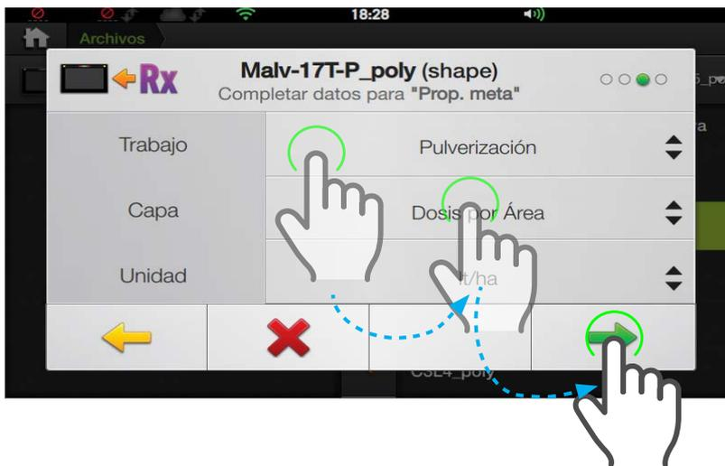
6. Completar los datos en pantalla y presionar **Siguiente**.
