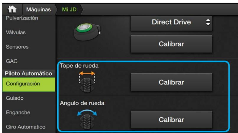
Si excepcionalmente se dispusiera de **Sensor de Rueda** será necesario realizar calibraciones de Topo de rueda y Ángulo de rueda.
