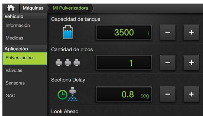
**Aplicación** agrupa los ajustes y calibraciones inherentes al SBOX7 Pulverización, y se distribuyen en los paneles:
