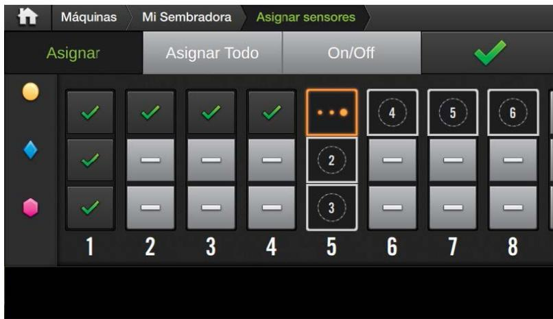
Cada vez que un sensor sea detectado se activará y se le asignará el identificador del sensor que se conectó.
