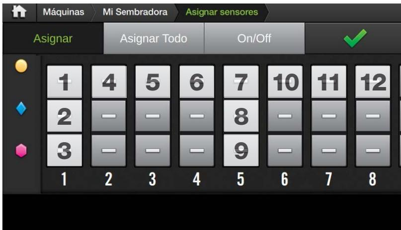
2. Tocar los sensores en el orden en que se conectarán físicamente en la máquina.
